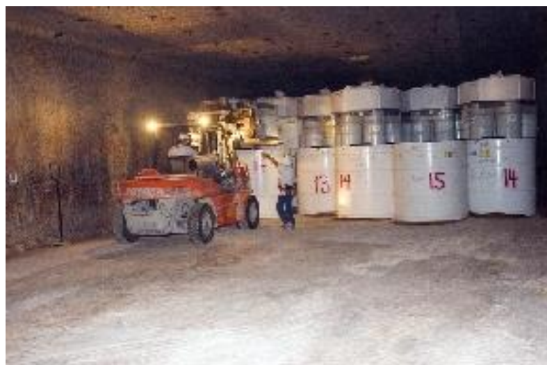
Image : Techniciens déposant des déchets contenant des transuraniens dans une unité pilote près de Carlsbad au Nouveau-Mexique. Via Wikimedia commons . Par DOE Photo. Domaine public.
